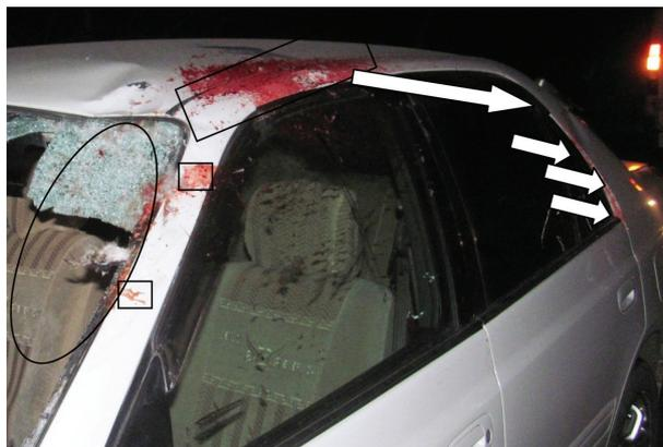
Рис. 2. Передне-боковая часть транспортного средства. Эллипсом обозначено место контакта тела потерпевшего с кузовом машины. Квадратами – места локализации мазков крови. Стрелками показано направление разбрызгивания капель крови
