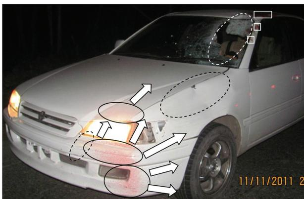
Рис. 1. Передняя часть транспортного средства, вид спереди и слева. Прерывистыми эллипсами обозначены места контакта тела потерпевшего с кузовом машины. Сплошными эллипсами – места локализации брызг крови. Сплошными квадратами – места локализации мазков крови. Стрелками показано направление разбрызгивания капель крови
