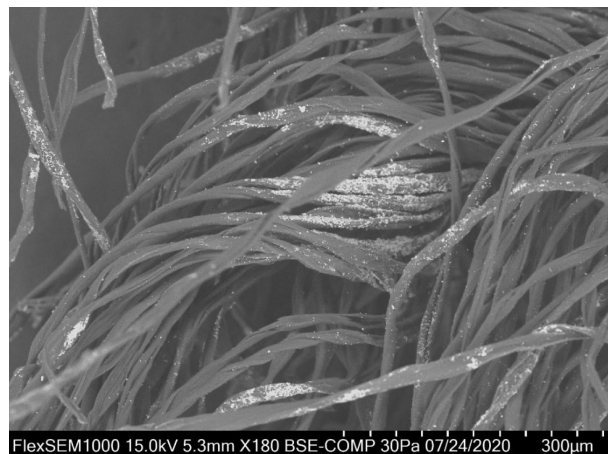
Рис. 2. Морфология распределения наложений твердых компонентов продуктов сгорания выстрела на волокнах нитей мишени из краевой зоны входного повреждения при выстреле с расстояния 30 см (исследование в режиме BSE-COMP, увеличение \times 180 )
