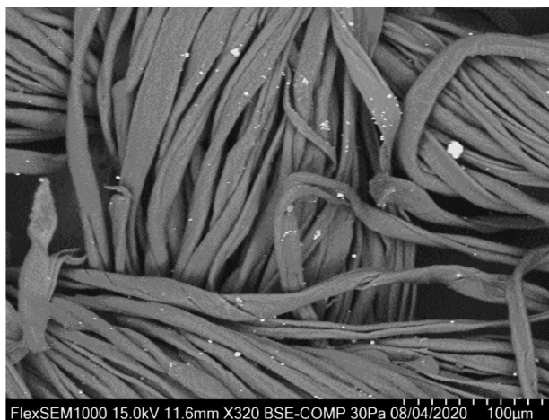
Рис. 5. Морфология распределения наложений твердых компонентов продуктов сгорания по периферии от входного повреждения при выстреле с расстояния 70 см (исследование в режиме BSE-COMP, увеличение \times 320 )
