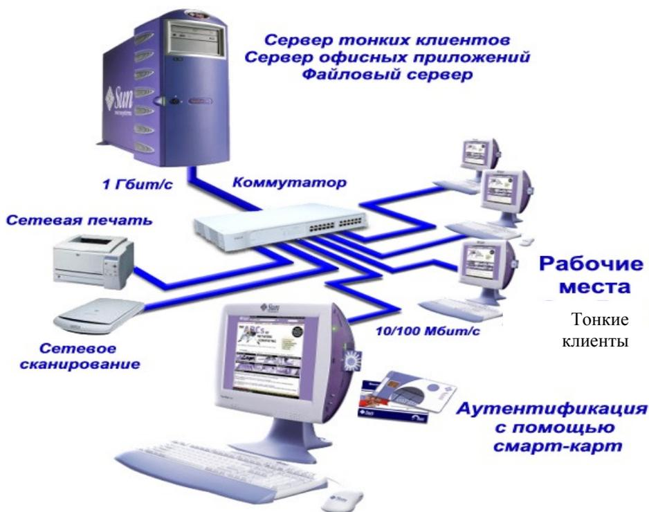
Рис. 1. Структура локальной сети с терминальным доступом.
