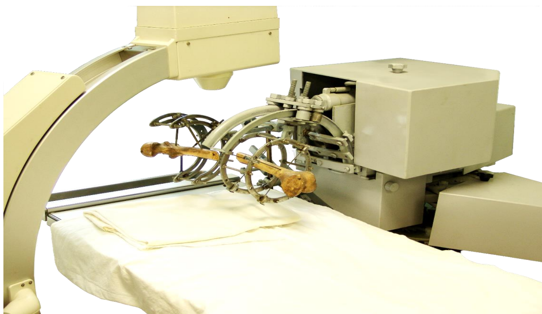
Рис. 5. Роботизированная система для одномоментной репозиции и фиксации костей скелета с дистанционным управлением.
